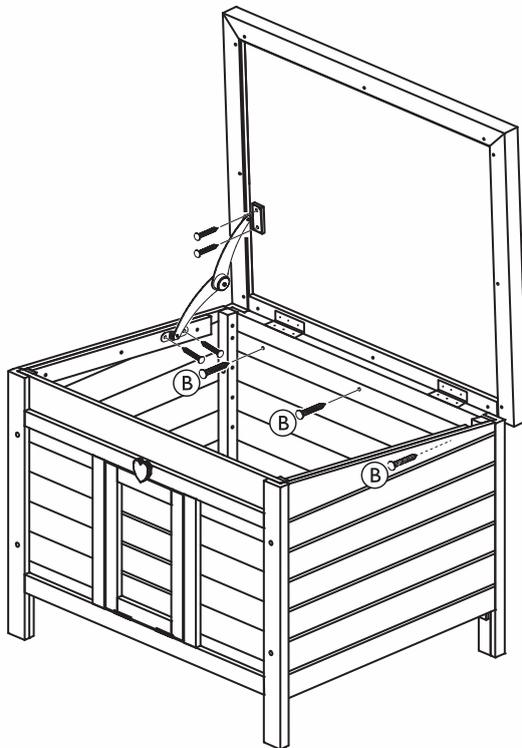
3. Befestigen Sie das Dach und fixieren Sie das Arretierungsscharnier.
