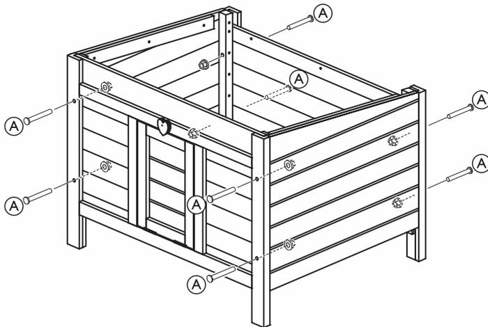
1. Verschrauben Sie das Vorder- und Rückteil mit den Seitenteilen.
